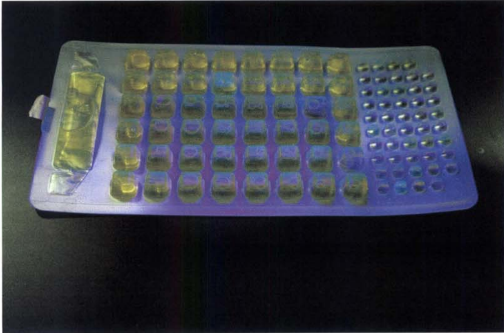
شكل رقم (١٥) يوضح اللون الأزرق الوضاء العدد التقريبي (M.P.N) لبكتيريا الاشرشيا كولاي (E-coli) في عينة مياه بعد فترة حضانة ٢٤ ساعة وتعرضها للأشعة فوق البنفسجية
