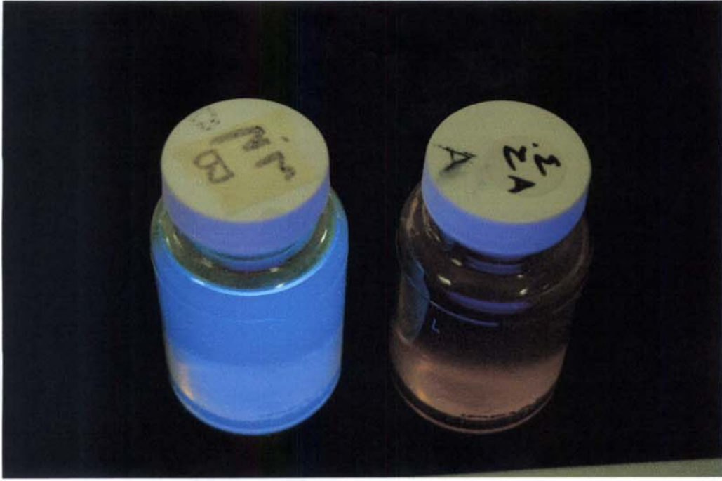
شكل رقم (١٤) يوضح اللون الأصفر على اليمين حالة تلوث بالبكتيريا القولونية (Coliforms) اللون الأزرق الوضاء على اليسار حالة تلوث شديدة بالاشرشيا كولاي (E-coli) في عينة مياه مأخوذة من مسلخ حذاء ببحرة وبعد فترة حضانة ٢٤ ساعة .
