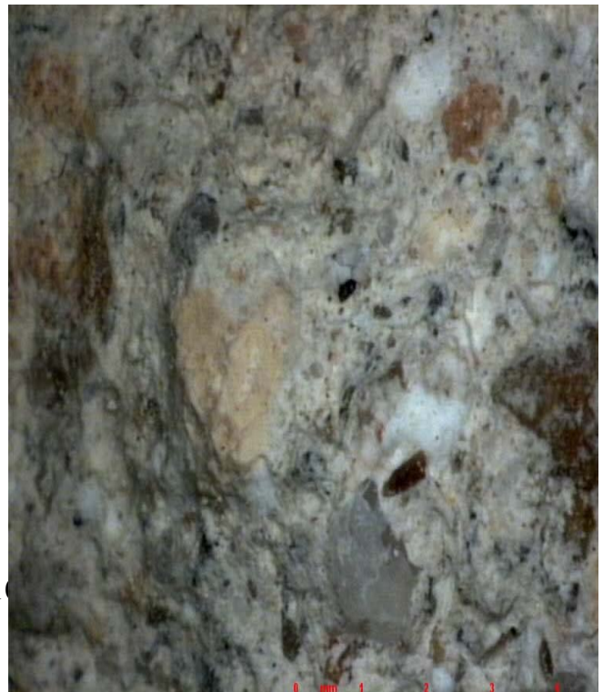
صورة رقم 6- عينة طلاء السد الثاني التي اظهرته الفيضانات بوادي القصب
