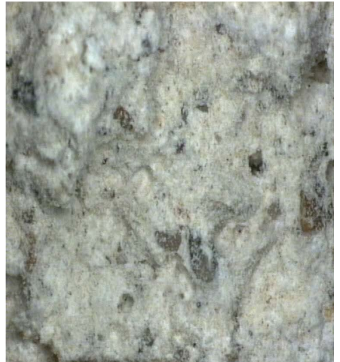
صورة رقم 8- عينة ملاط السد الثالث بالجزء الموجود على الضفة اليمنى بوادي القصب
