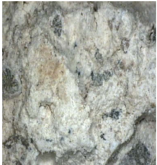
صورة رقم 4- عينة ملاط ارضية خزان موجود بسد الجساسية بوادي لقمان
