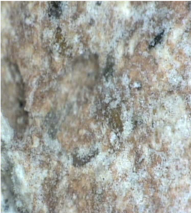
صورة رقم 8- عينة ملاط السد الثالث بالجزء الموجود على الضفة اليمنى بوادي القصب
