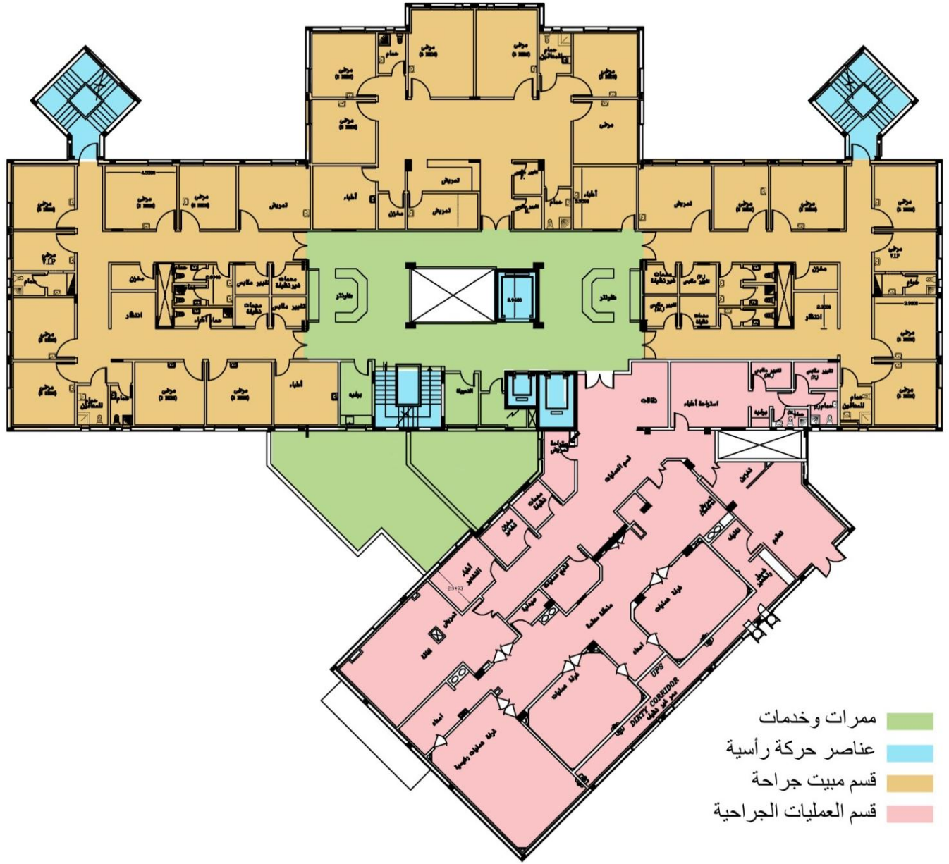
شكل رقم (٤-٥٨): مخطط الطابق الثالث لمستشفى شهداء الأقصى. المصدر دائرة المكتب الهندسي بوزارة الصحة - الباحثة
