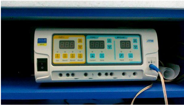
شكل رقم (٣-٢٢) صورة توضح جهاز التخثير الكهربائي المصدر: www.doctor-firas.com,2010
