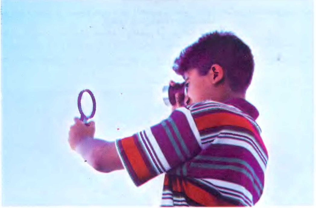
اختبار أولى لعدسة لمعرفة طول قصبه تلسكوب كبلر
