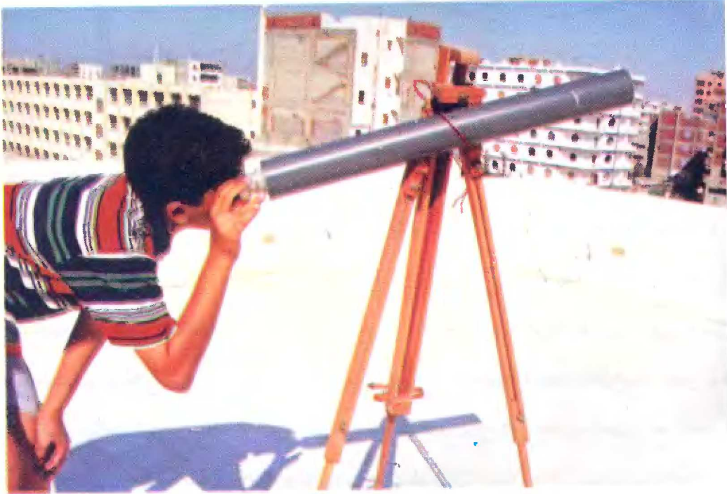
اختبار تلسكوب كاسر بمشاهدة طبق تليفزيون بعيد
