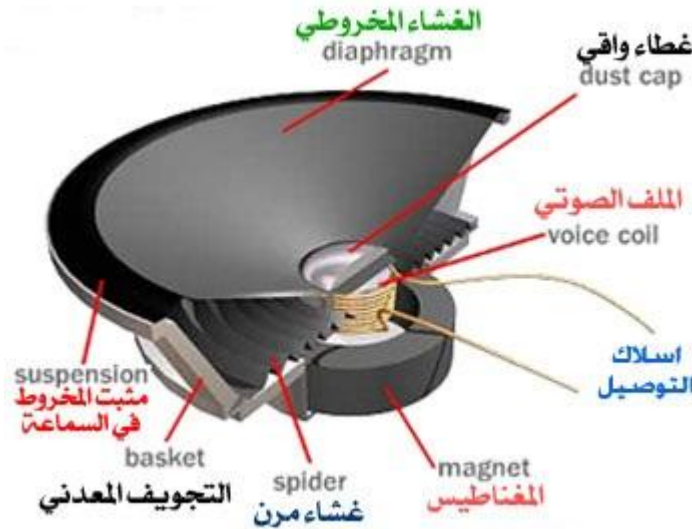
الشكل ( 2-3 ) يوضح مكونات السماعة
