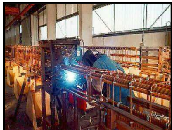
تجهيز القفص الحديدي لكمره سابقة الصب
