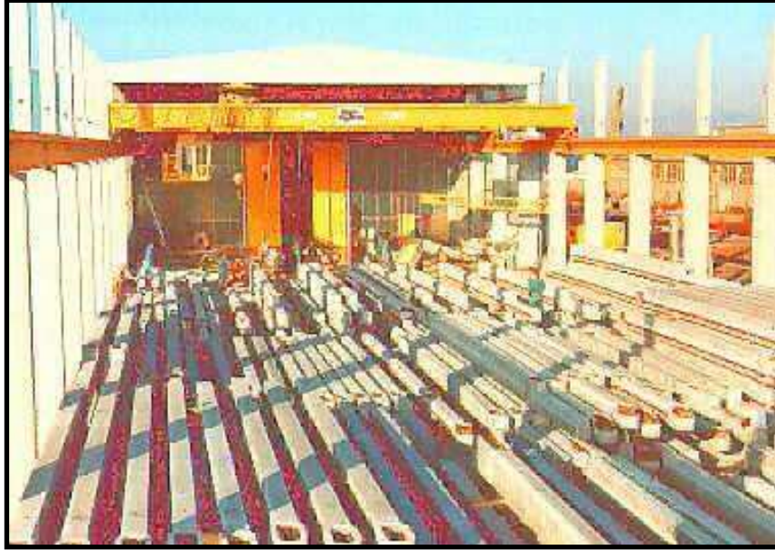
تخزين الوحدات الخرسانية التي تم صبها و تصلدها بطريقة فنية
