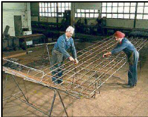
تجهيز حديد التسليح لبلاطة سابقة الصب
