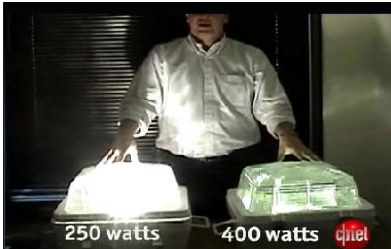
الشكل يوضح الفرق بين المصباح العادي ومصباح ذو تقنية البلازما
