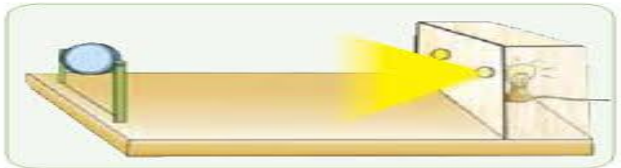
شكل (٩) تعيين نصف قطر تكوير المرآة المقعرة
