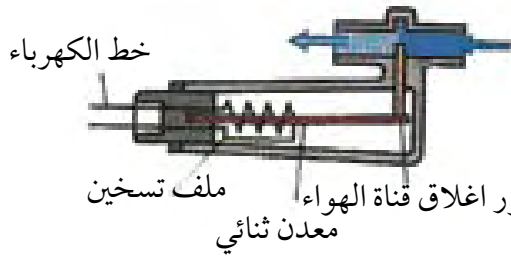
شكل (١٣) صمام الهواء الإضافي
