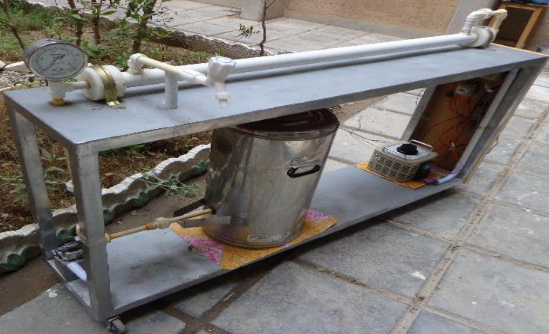
شكل (5): صورة فوتوغرافية من الأمام لجهاز بسترة الحليب بالمجال الكهربائي المصنع محلياً.
