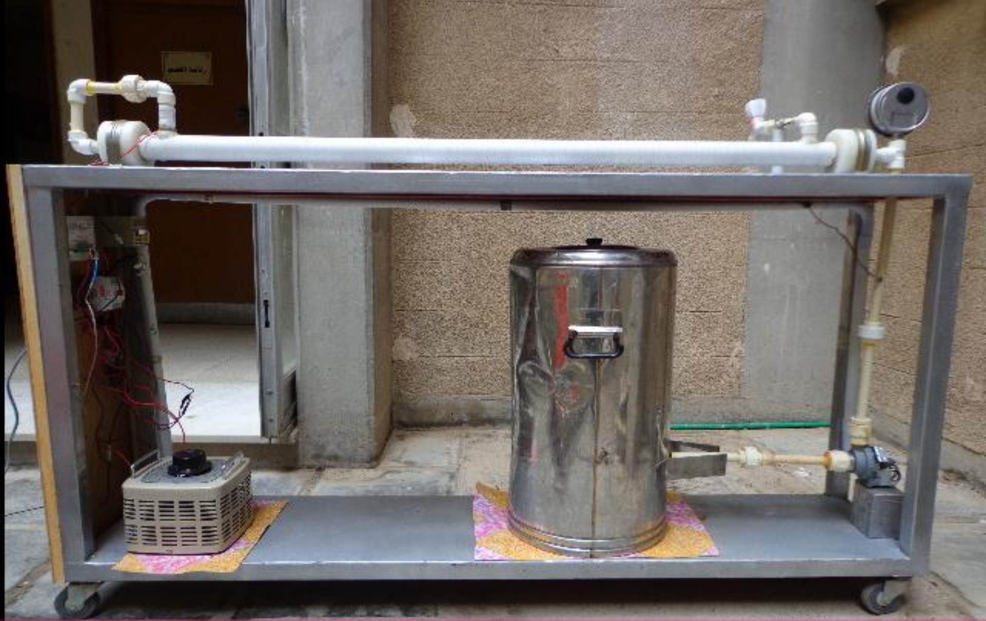
شكل (4): صورة فوتوغرافية من الخلف لجهاز بسترة الحليب بالمجال الكهربائي المصنع محلياً.
