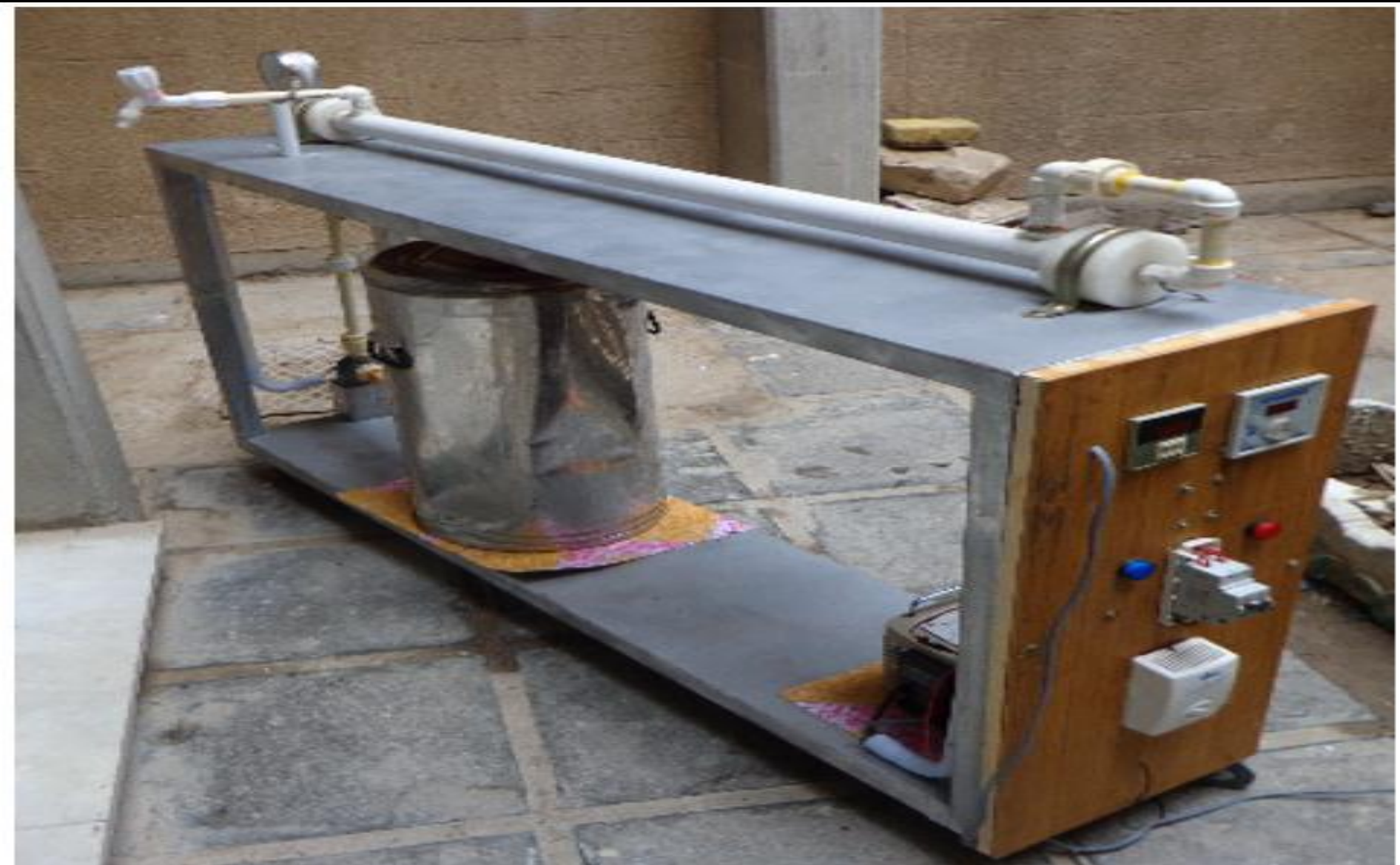
شكل (٣): صورة فوتوغرافية من الزاوية لجهاز بسترة الحليب بالمجال الكهربائي المصنع محلياً.
