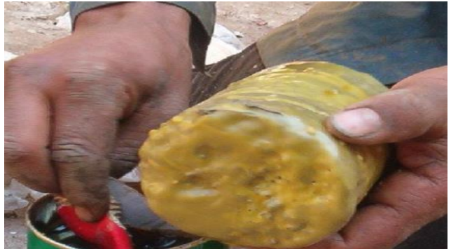
11- يتم الحفاظ على خواص العينات المتماسكه بتغليفها بالشمع بعد اذابته
