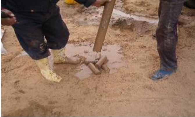
12- في حالة عدم توافر الشمع يتم وضع العينات في اكياس بلاستيكيه وحفظها بعيداً عن الشمس
