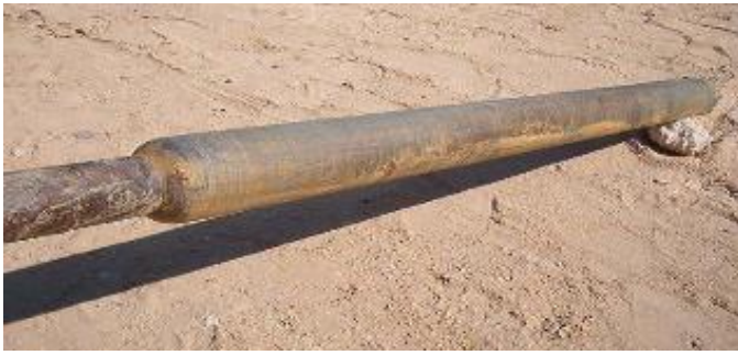
10- يتم فك الماسوره واخراجها ثم يتم تفريغ العينات حتى يتم حفظها
