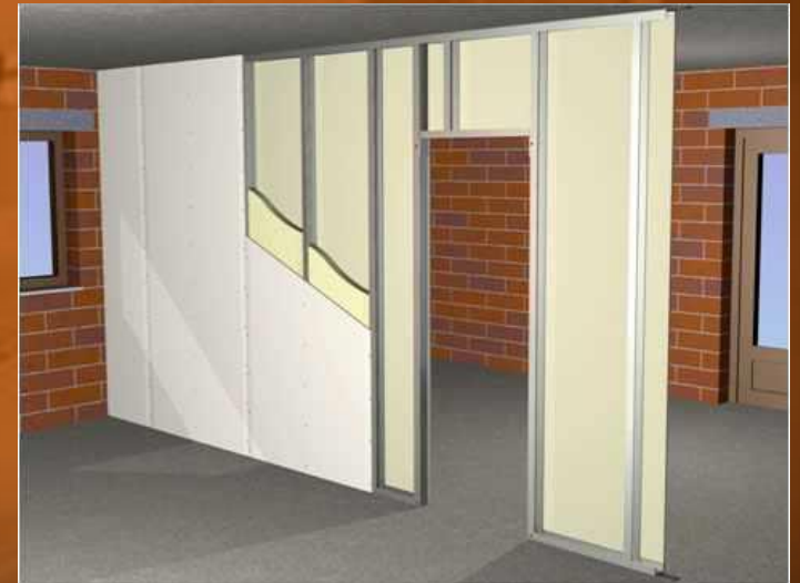
مراحل تركيب القواطع الجبسية
