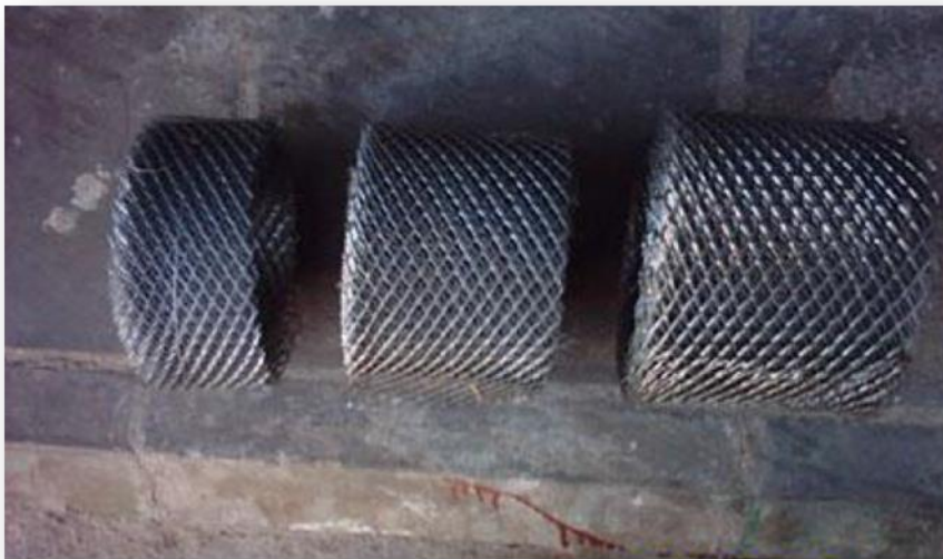
تغطية أماكن اتصال الحائط بالخرسانة بشبكة ممدد من السلك المجلفن
