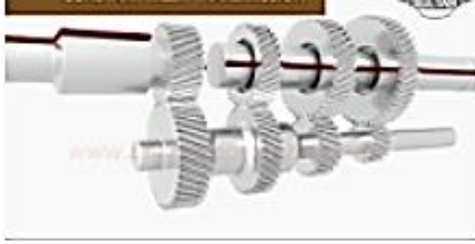
الشكل رقم (2-3) يوضح حالة السرعات لصندوق التروس
