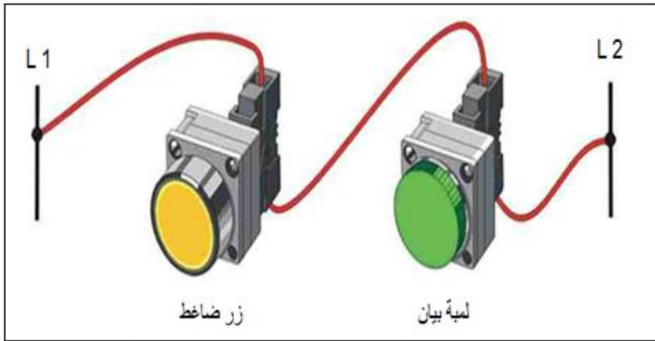
الشكل رقم (٤٩) : العلاقة الوظيفية بين الزر الضاغط ولمبة البيان
