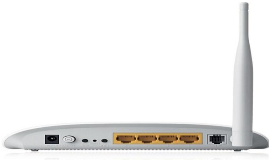
Fig2 : point d'accès. (ModemTD-W8951ND 150Mbps Wireless N ADSL2 + Modem Router):
