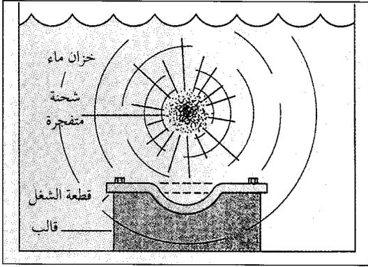
التشكيل ذو الطاقة العالية يستخدم شحنة متفجرة لدفع لوح الفلز في انحناءات القالب.
