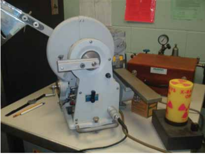
شكل رقم (٩-١) جهاز قديم مفتوح يستخدم في تحليل العينات بواسطة حيود الأشعة السينية [٢٤].
