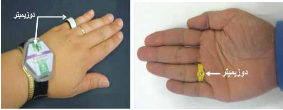
شكل رقم (٧-٩) نماذج مختلفة من بلورات TLD، ذات تصاميم عدة؛ تلبى متطلبات قياس الجرعة لليد أو الأصابع، وتستخدم مراراً بعد معالجتها حرارياً [١٠٦-١٠٧].
