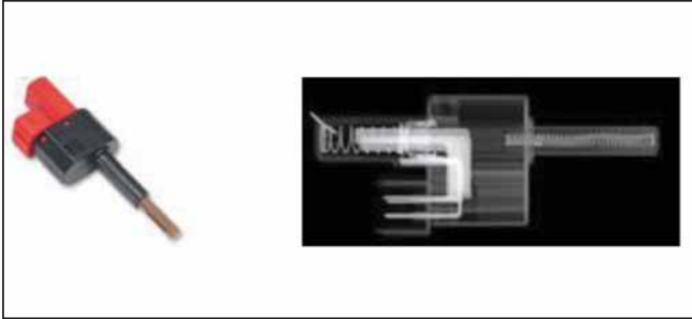
شكل رقم (٦-٣) صورة رقمية بالأشعة السينية لمكونات مفتاح السيارة؛ لاختبار المكونات الداخلية [٩].
