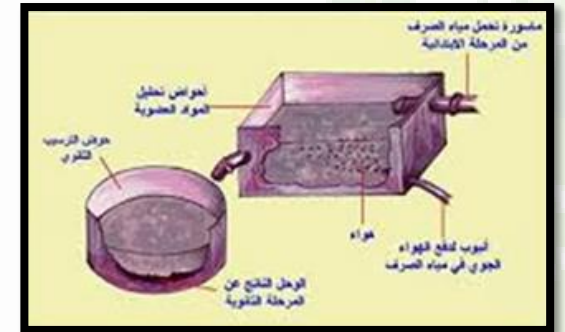
شكل توضيحي لخطوات المعالجة الثانوية
