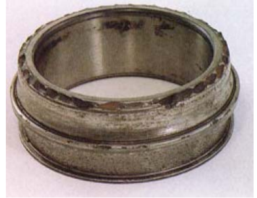
الحلقة الداخلية لمسير الأسطوانات نتيجة حمل أو قوة زائدة
