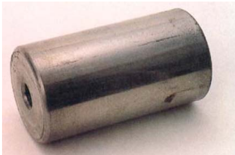
أسطوانة لمحمل أسطواني نتيجة عدم الخبرة عند تركيب المحمل
