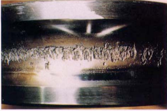
مسير حركة الكرات الحلقة الداخلية نتيجة قوى محورية زائدة
