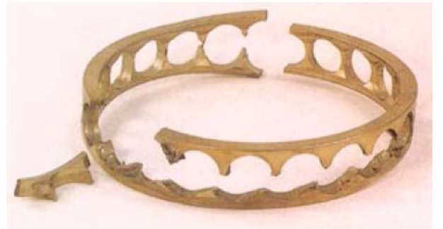
الحلقة القفصية للكرات نتيجة عدم التزيت
