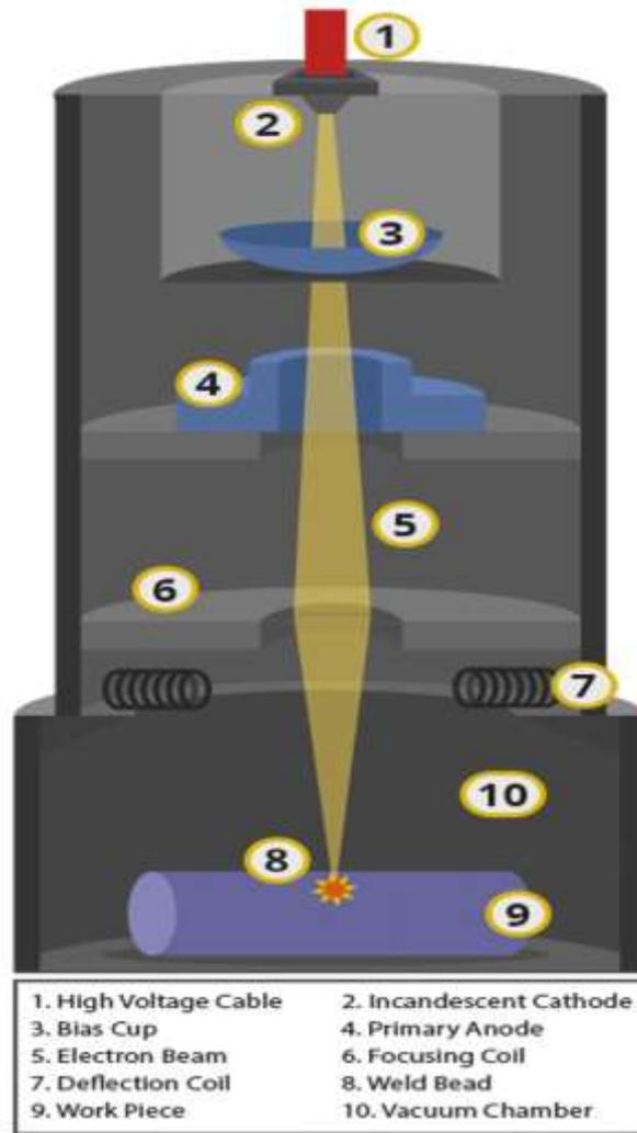
طورت من قبل الشركة السويدية أركام (Arcam) كطريقة للطباعة على المعادن و التي تشبه الى حد كبير تلبد المعدن بالليزر المباشر ( Direct Metal Laser Sintering) (DMLS) في القطع المطبوعة لاستخدامها مسحوق المعدن و الأختلاف بينهما هو مصدر الحرارة و التي كما يوحي أسمها شعاع الألكترون بدلا من الليزر . و هذا يتطلب أن يتم في ظروف الفراغ الجوي .
