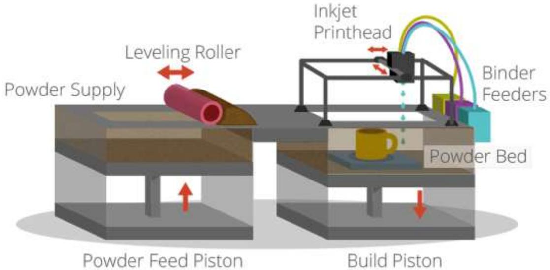
تنفث المواد الرابطة بواسطة رأس النفث على مضجع المواد المسحوقة في الاسفل ، حيث ترش المادة الرابطة بصورة انتقائية على مضجع المواد المسحوقة و تؤدي الى اندماج جزء من المواد في طبقة لطباعة القطعة المطلوبة ، و بعد الانتهاء من الطبقة الأولى تهبط مضجع المواد تدريجياً و تقوم رولة أو شفرة بدفع المسحوق الى سطح المضجع ثم يقوم الرأس النافث بقذف المادة الرابطة و حسب شكل القطعة المطلوبة طباعته بلصق المواد المسحوقة حيث تتشكل هذه الطبقات و تتحد مع بعضها لتكون بالنهاية القطعة المطلوبة .
