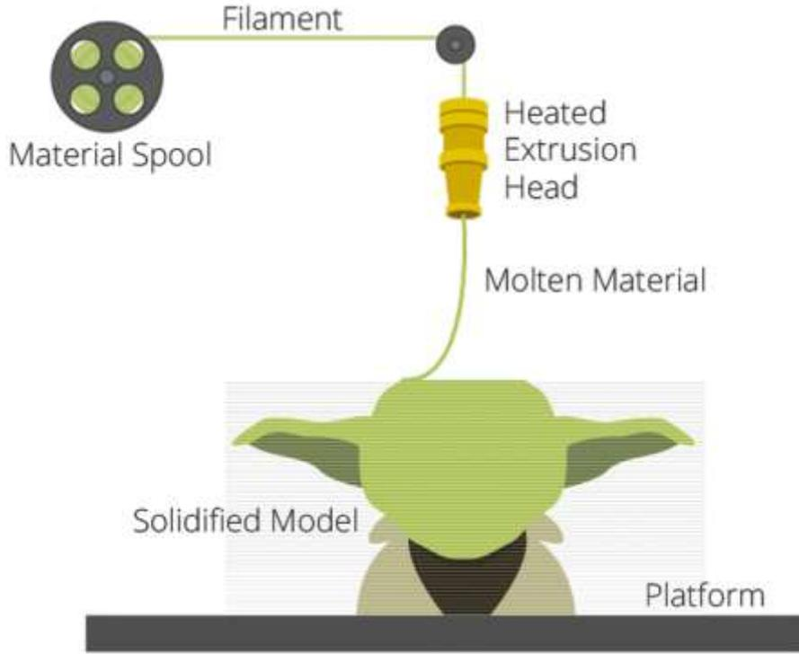
تستخدم في هذا النوع من الطباعة ثلاثية الأبعاد مواد بلاستيكية حرارية و ذلك بنفثها خلال قاذف او نافث و هي واسعة الانتشار . و تسمى بشكل عام بنمذجة مترسب المنصهر (Fused Deposition Modelling) (FDM) و هذه التسمية التجارية المسجلة من قبل ستراتس (Stratasys) و هي الشركة الأصل التي طورتها .
