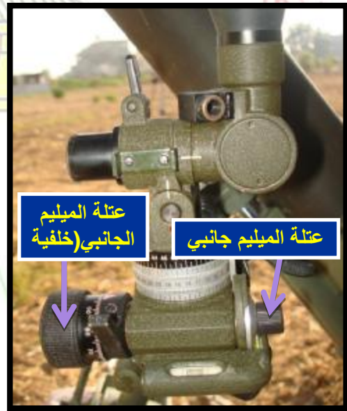
١- توجيه عين المنظار باتجاه الخطأ عن طريق عتلة الميليم الجانبي.
