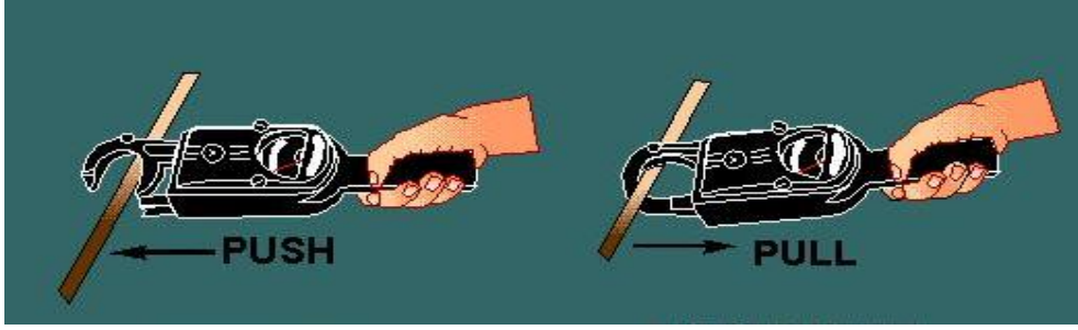
الشكل ١٠: محول التيار ذو القلب الحديدي المشطور مزود بأميتر
