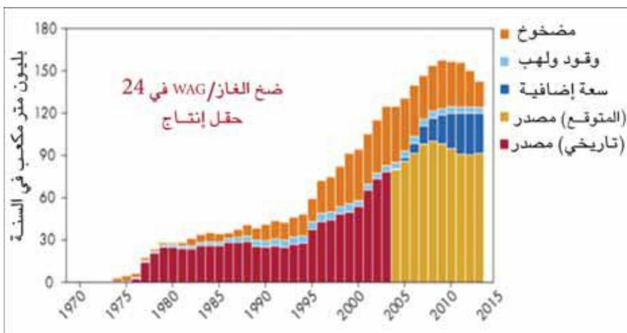
الشكل (2 – 16) : التوجه في حقن غاز الهيدروكربون من أجل استخراج مكثف للنفط في الترويج
