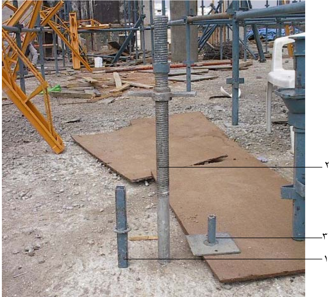
شكل رقم (٨٥) يبين بعض مكونات الشدة المعدنية
