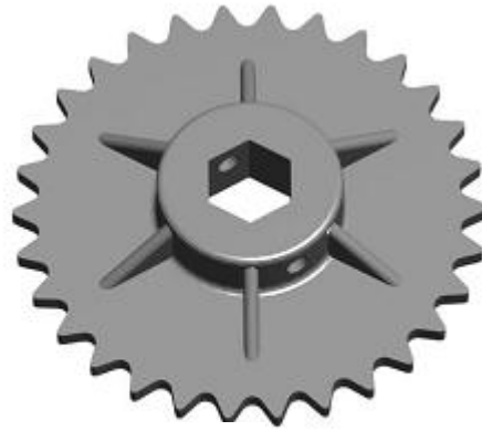
شكل (36) يبين نوع البكرة المسننة بوجود كتف Hub
