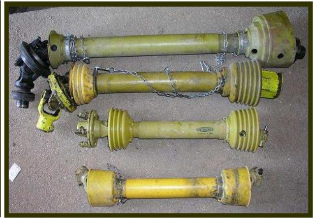
الشكل رقم (11) يبين شكل وطريقة التثبيت على عمود نقل القدرة P. T. O الخلفي في الساحبة
