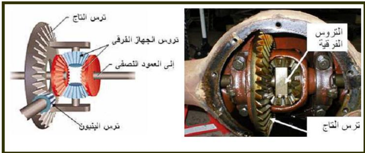
شكل رقم (14) الأجزاء التي يتكون منها الجهاز العمودي والجهاز الفرقي
