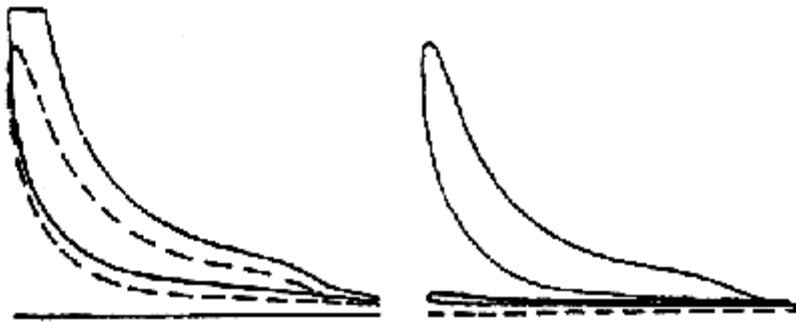
(هـ) جزرة المبين بها تفويت - خط الضغط الجوي غير صحيح (و) النابض (اليابي) ضعيف جداً بحيث يخبط الكباس في نهاية الاسطوانة
