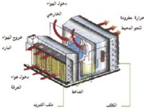
شكل ٧-٣ رسم تخطيطي لوحدة تكييف شبك
