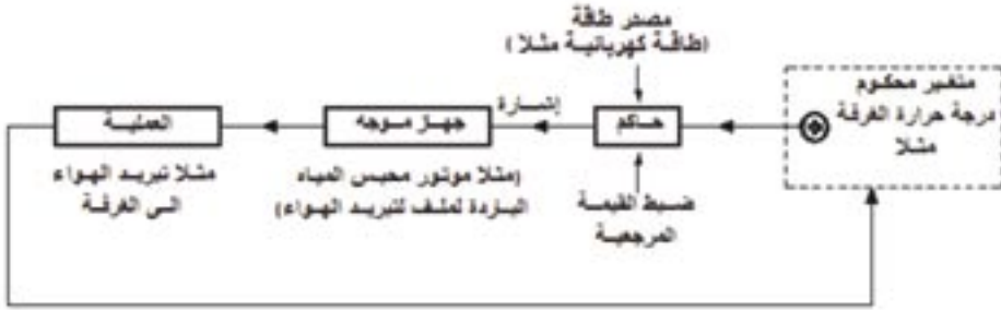
شكل ٩-١ مكونات دائرة التحكم
