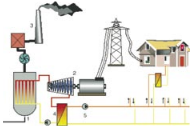
شكل ٨-١٠ محطة ثنائية التوليد
