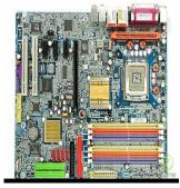
توجد اللوحة الأم (لوحة النظام) داخل وحدة النظام ويتم توصيل كل مكونات الحاسوب الأساسية بشكل مباشر بها. وتوجد وحدة المعالجة المركزية في لوحة النظام إلى جانب المكونات الإليكترونية الأخرى. ويتم توصيل مكونات أخرى مثل القرص الصلب بهذه اللوحة بشكل مباشر أو من خلال كابلات. إن هذه اللوحات يقل حجمها يومًا بعد يوم لأن المكونات تصبح أكثر دمجًا. فإذا قمت بفتح أية وحدة حاسوب حديثة، فلن تجد غير مكونات صغيرة جدًا.
