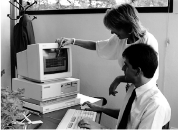
شكل ي ٢-١٢ : وحدة UPS للخطوط الدقيقة يمكن أن تكون ملازمة للحاسوب الشخصي
