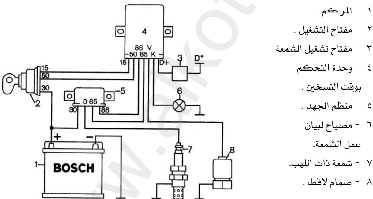
شكل (٢٥) يبين الدائرة الكهربائية لتوصيل شمعة التسخين ذات اللهب .
