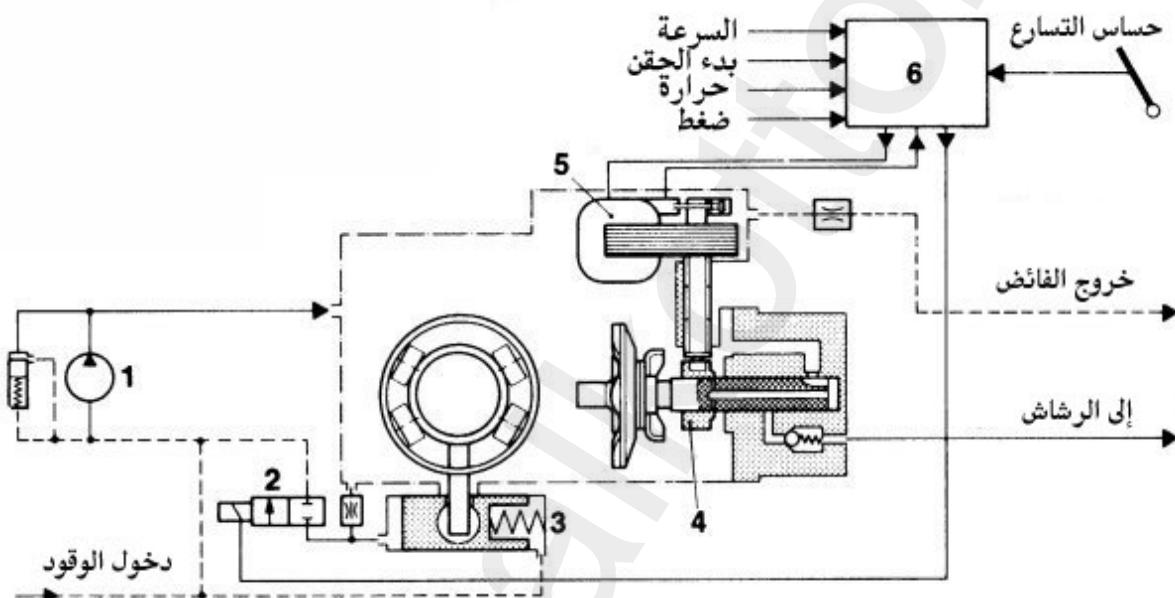
الشكل ( ٣٤ ) يوضح مخطط دائرة حقن الديزل الكهربائي لمضخة حقن دائيرية
