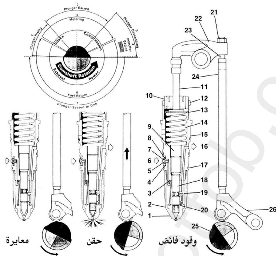
شكل (٢٩) يبين حركة الكامة و إبرة الرشاش في عملية الحقن
