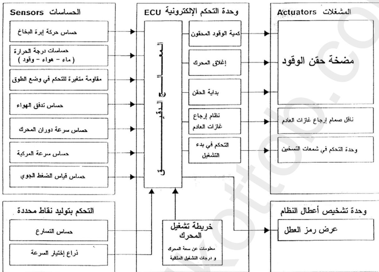
شكل (٣١) يبين مخطط منظومة حقن الديزل بتحكم كهربائي وأجزاءه الأساسية
