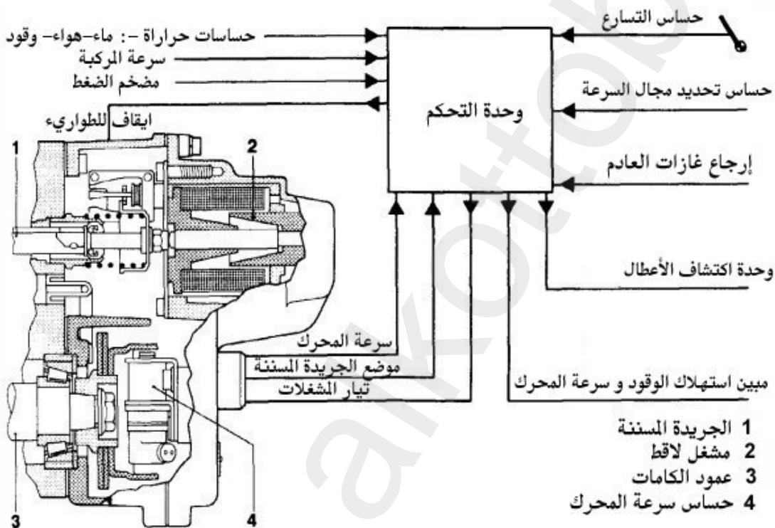
يظهر مخطط كيفية اتصال منظم الحقن بدائرة التحكم الكهربائي لمضخة مستقيمة
