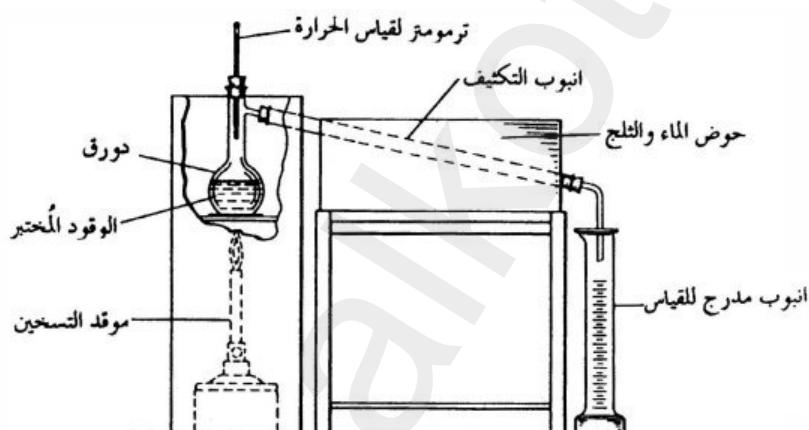
جهاز اختبار نقطير الوقود ( المعهد الأمريكي لاختبار المواد ) (ASTM)
