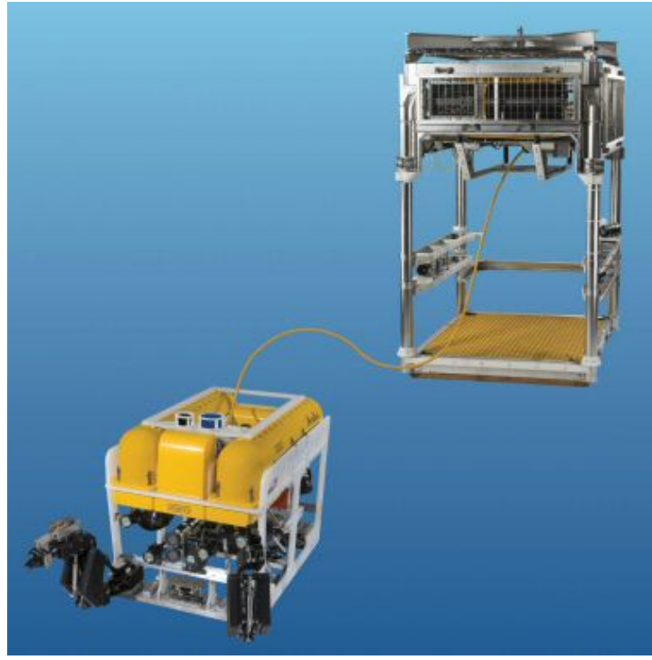
منظومة إدارة الرابطة TMS Tether Management System
