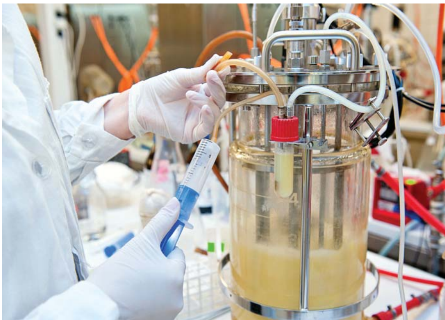
■ أحد المفاعلات الحيوية التجريبية حيث يضاف لها مصادر لتغذية الكائنات الدقيقة.
