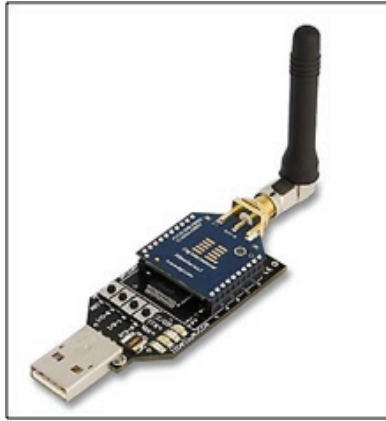
شكل ٢١ (وحدة محطة رئيسة يمكن توصيلها بالحاسوب) [١١٤]
