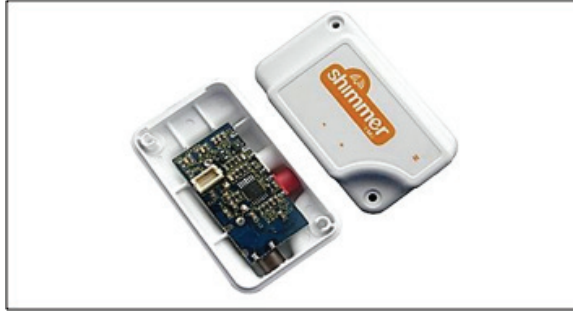
شكل ٤٦ (عقدة لاسلكية تقوم بعمل جهاز التخطيط الكهربائي للعضلات) [١٢٥]
