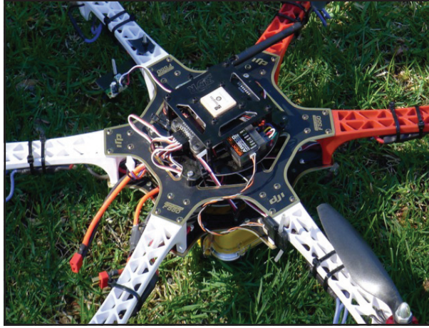
شكل ٣٣ (طائرة بدون طيار مزودة بوحدة حساس لاسلكي لقياس نسبة الإشعاع) [٩٧]
