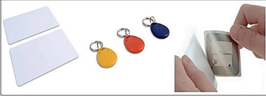
شكل ٢٠ (شرائح مختلفة للتعرف بواسطة موجات الراديو) [١١٨]
