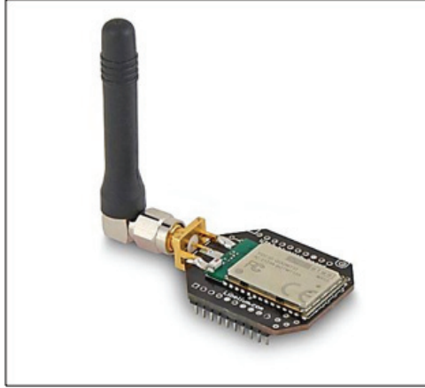
شكل ١٧ (وحدة بلوتوث إضافية تستخدم للتعرف إلى أجهزة بلوتوث في المنطقة المحيطة) [١٣٤]
