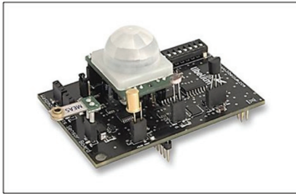
شكل ٣٥ (لوحة عقدة لاسلكية لاكتشاف الحركة) [١١٤]
