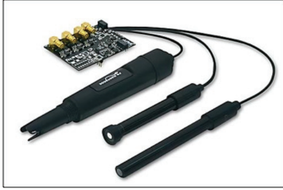
شكل ٣٨ (لوحة عقدة لاسلكية تستخدم في تطبيقات المدن الذكية) [١١٤]
