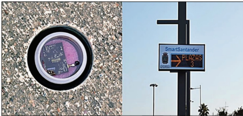
شكل ٤١ لوحة توضّح عدد الأماكن الشاغرة لانتظار السيارات (يمين)، عقدة حساسات لاسلكية مثبتة في الأرض تستخدم لتحديد الأماكن الشاغرة في مواقف السيارات (يسار) [١٢٩]
