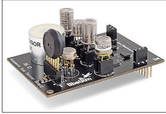
شكل ٣٠ (لوحة عقدة لاسلكية تستخدم للكشف عن الغازات) [١١٤]
