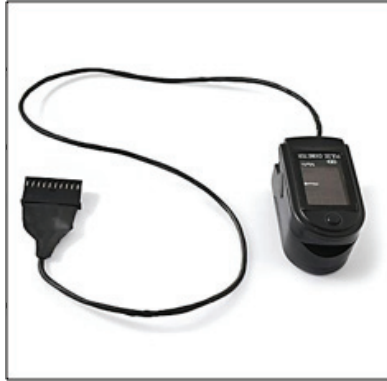
شكل ٤٦ (عقدة لاسلكية تقوم بعمل جهاز التخطيط الكهربائي للعضلات) [١٢٥]
