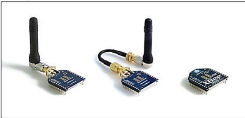
شكل ٩ (أنواع موصلات هوائيات مختلفة تُستخدم في وحدة الإرسال والاستقبال) [١١٤]
