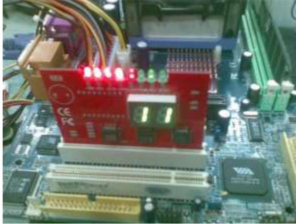
بعض أنواع كروت التشخيص المتطورة لا تحتاج لجدول لترجمة أكواد الأخطاء ولكنها مزودة بشاشة صغيرة تظهر عليها رسائل نصية قصيرة بالأخطاء وبعضها مجهز لإختبار الفولتات الأساسية التي تحتاجها الدوائر الإلكترونية حتى يمكنها العمل بصورة سليمة.
