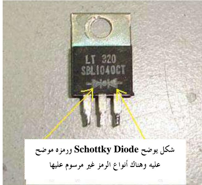
شكل يوضح Schottky Diode ورمزه موضح عليه وهناك أنواع الرمز غير مرسوم عليها
