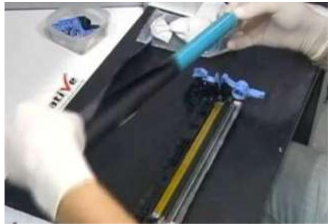
٦. لتنظيف الأجزاء الداخلية استخدم سائل مع قماشة جافة وبللها بالسائل بشكل بسيط ثم قم بمسح الأجزاء المتسخه
