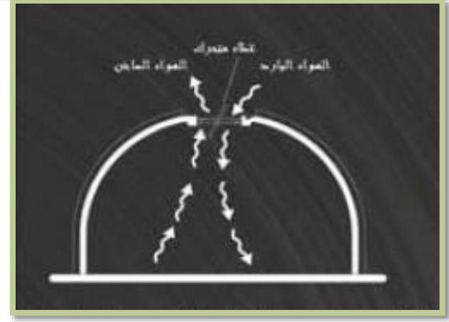
قطاع توضيحي لنظام التهوية الطبيعي
