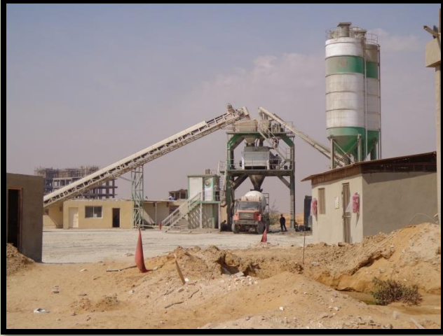
طريقة تعبئة العربات بالخرسانة الجاهزة
