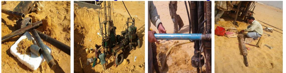
اختبار الدقات او ال S P T يعنى standard penetration test
