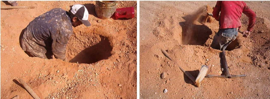
يتم عمل حفر الاختبارات المكشوفة يدوياً باستخدام بعض الأدوات المستخدمة باليد
