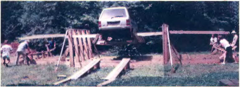
محاولة من أحد المهندسين الأجانب لتوضيح كيفية بناء الهرم برافعات (السيارة بديل عن الكتلة الحجرية).
