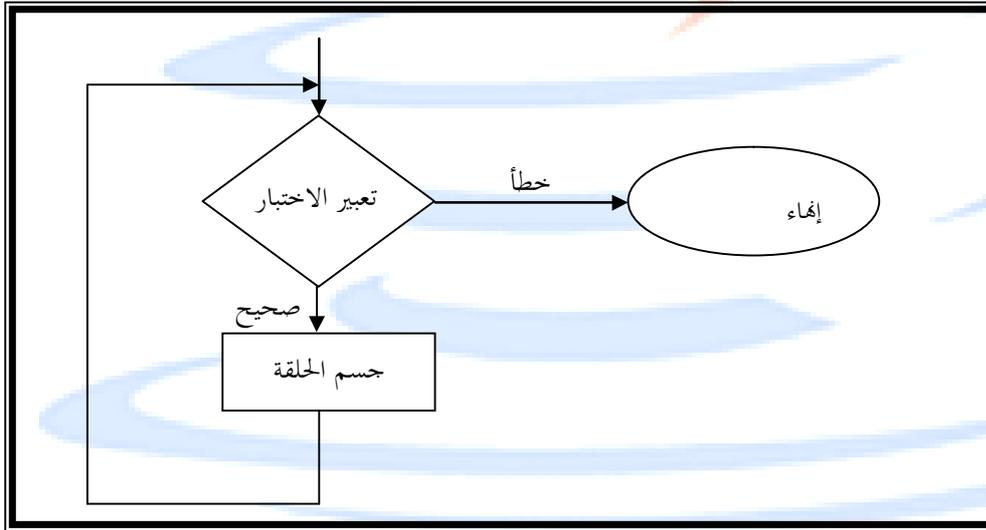
شكل (٣-١) - طريقة عمل الحلقة while
