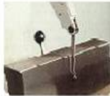
شكل (5-6): أمثلة لقطع ذات أشكال مختلفة أثناء قياس تفاوتات أسطحها.
