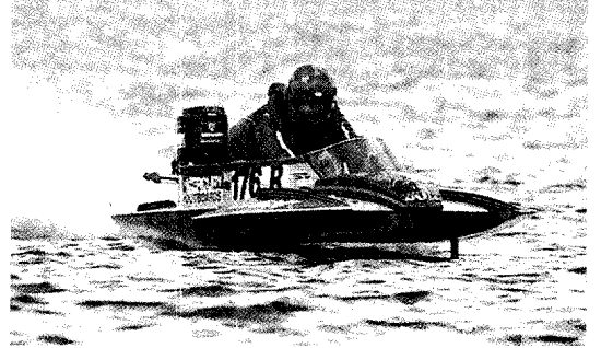
الزورق البخاري السريع ينزلق على سطح الماء فوق وسادة هوائية. قاع جسم هذه القوارب مسطح أو به ميل قليل.
