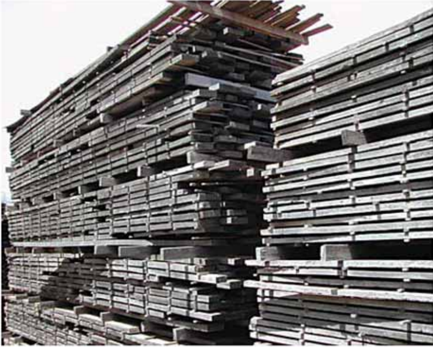
(الشكل 10.4) تجفيف الخشب من نوع جارا (Jarrah) بالهواء في غرب أستراليا.
