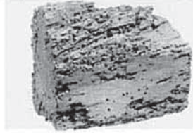
خنفسا طويلة المنقار ( Hylotrupes bajulus ) الحجم الحقيقي والطول 2.5 mm تلف تقليدي في العوارض
