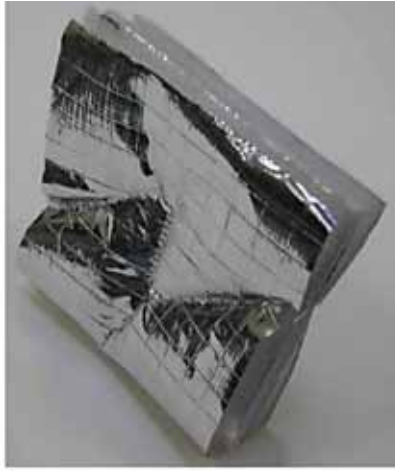
(الشكل 4.13) نظام عزل برفائق الألومنيوم متعددة الطبقات.
