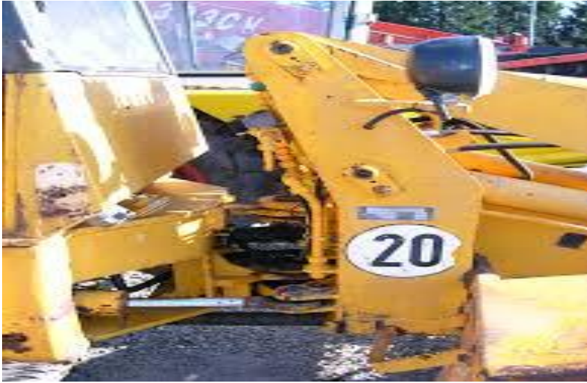
الشكل (4-6) جرافة ذات عجلات C966 - أسطوانة التوجيه
