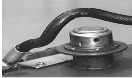
الشكل (21-4) التواء الخرطوم
