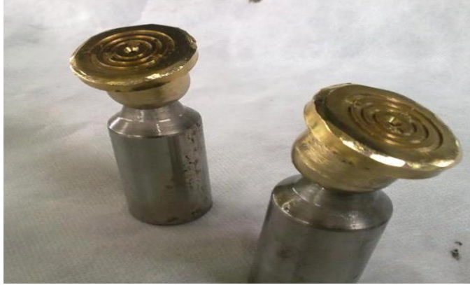
الشكل (24-4) تلف بمكابس الموتور
