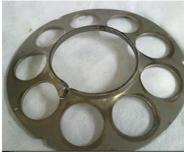
الشكل (25-4) تلف بلوحة المحرك
