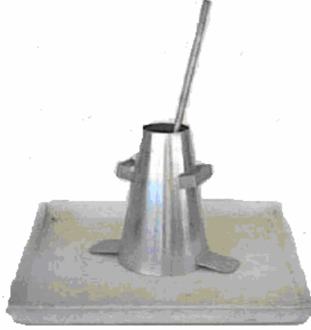
شكل 10: مخروط ناقص وقضيب لاختبار الهبوط
