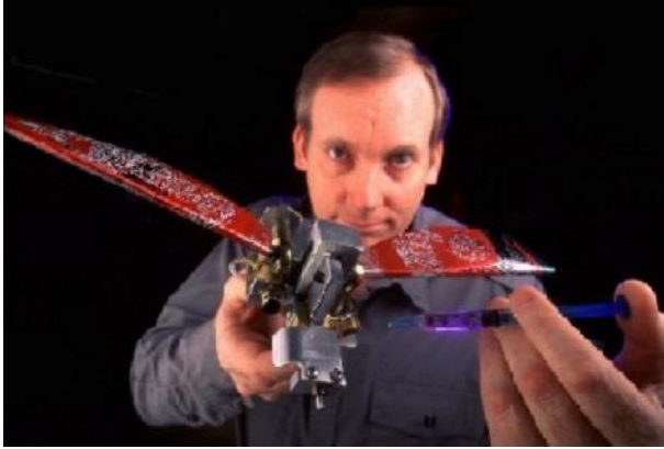
النموذج الأولي للإنتوموبتر "الآلة الحشرية المجنحة"... يمكن رؤية المادة الكيميائية التي يتم حقنها في الإنتوموبتر لتحريك العضلة الدوارة.
