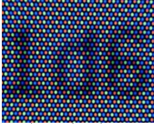
شكل (13) عناصر الشاشة الملونة Triads أثناء إظهار صورة
