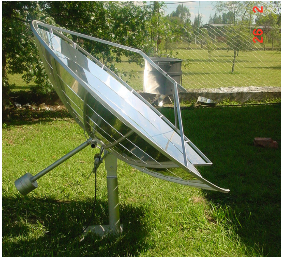
شكل (5-10) : المركز الشمسي التقليدي. (Franco et al.,2004).
