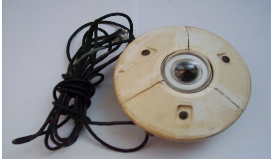
شكل (1-2) : جهاز البايرونوميتر لقياس شدة الاشعاع الشمسي.(الحلفي, 2006)
