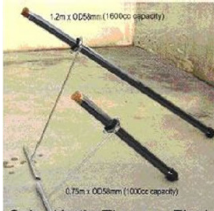
شكل (5-21) بسترية الماء بالانبوب الزجاجي المفرغ بحجوم مختلفة. (Yak,2006).
