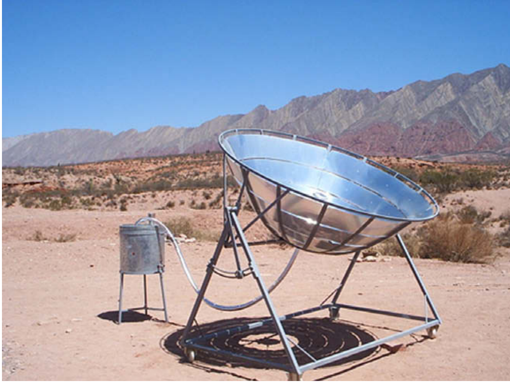
شكل (5-6): جهاز بسترية حليب الماعز بالطاقة الشمسية باستخدام المبيستر الشمسي المركز. (Franco et al. , 2004)
