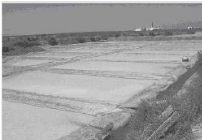
شكل (1-9): استخراج الملح شمسيا بالطريقة التقليدية.
