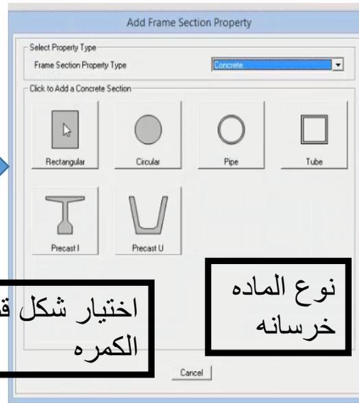
اختيار شكل قطاع الكمره
