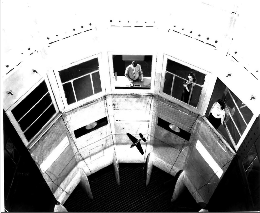
الشكل 9-2 نموذج طائرة ينهار حلزونياً في قسم اختبار الانهيار الحلزوني الحر في النفق الهوائي الذي يبلغ ارتفاعه 20 قدماً والموجود في وكالة الناسا (من : Neihouse, Kliner, and Scher, NASA Rept. R-57, 1960).
